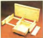
2. Две планки на верхней полке (1) предотвращают задвигание выдвинутых ящиков за откидную крышку.
